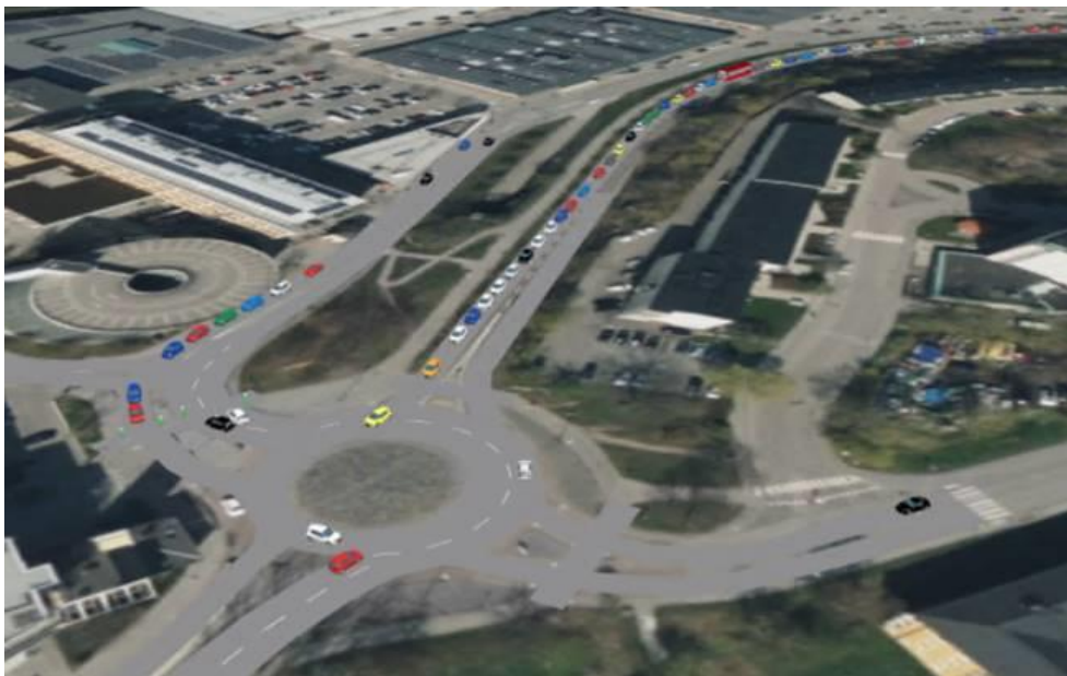
Figur 11 Trafikanalys av Gillerondellen i VISSIM. Scenario 2040 utan förlängning av Planiavägen. Halverat antal korta resor under 3 km. Källa M4 Traffic.
